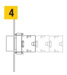
В одну конструкцию можно установить до 6 блок-контактов (3 пары).
